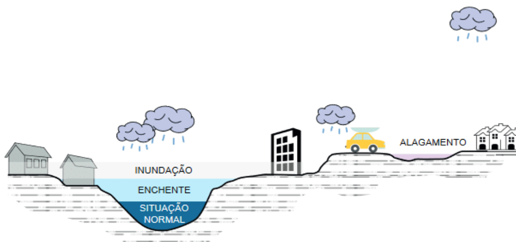
Figura 7 – Leitos de escoamento e problemas de drenagem.
