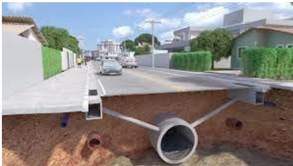
Figura 4 – Ilustração representando a integração dos sistemas de micro e macrodrenagem.
