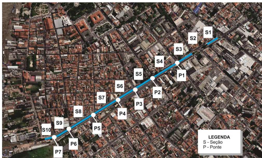
Figura 26 – Seccionamento dos trechos do canal da Tamandaré.
